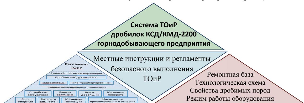
Рисунок 1 – Роль и место регламентов ТОиР в пирамиде элементов системы технического обслуживания и ремонта предприятия (на примере конусных дробилок КСД/КМД-2200)
